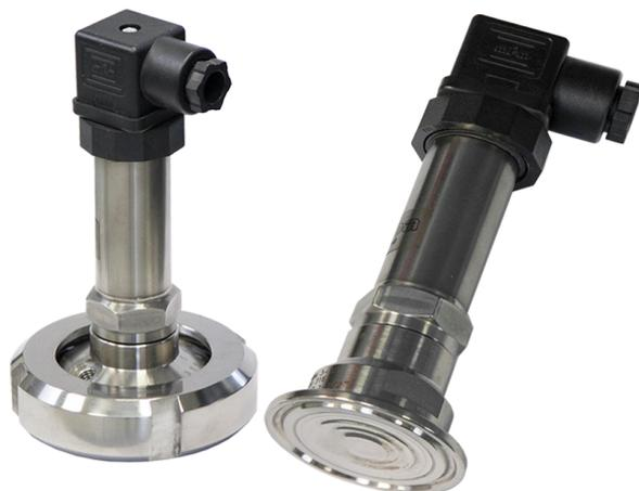
Esta serie de instrumentos ha sido diseñada para la transmisión de presión. Los transmisores de presión detectan la presión de líquidos y fluidos gaseosos al transformar el valor en una señal eléctrica. El sensor utilizado es piezorresistivo, que consiste en un puente de Wheatstone cuyas resistencias se difunden en un chip de silicio. Transmisor de presión con sensor cerámico y señal calibrada, compensada y amplificada. Se suministran con salida de corriente.
